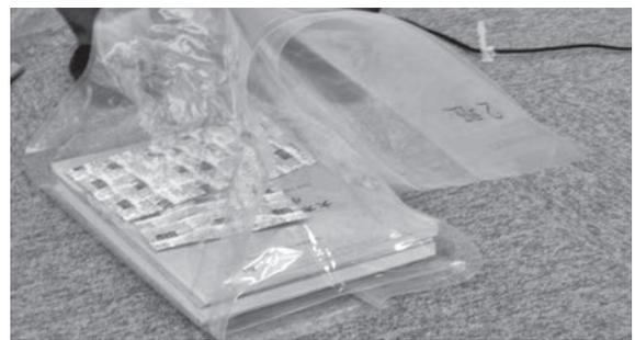
図77 低酸素脱酸素処理法(RP法)
